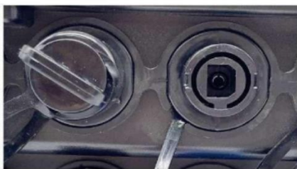
External side: Mini SC coupler
